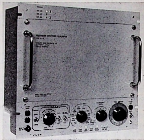
Moderne constructie van een TV-Waveform Generator van Ferguson Radio Corporation, Middlesex, uitgebracht in Montreux.
